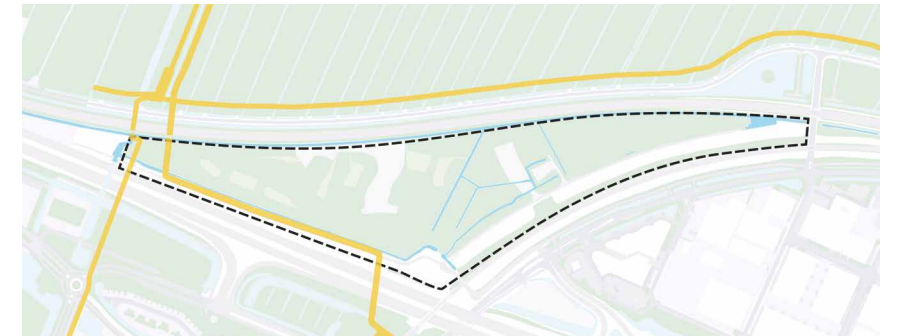
Figuur 21: Aardgasleiding met belemmeringsstroken
